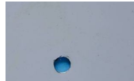
□ Muestras expuesta en un ambiente C4 durante un año. Arriba: inicio de "blistering"
